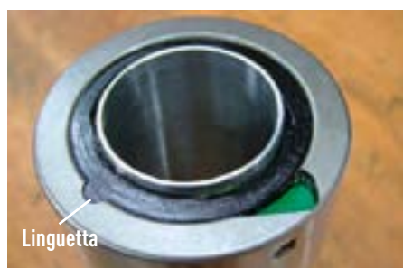
Fig. 10.3 Prima dell'assemblaggio, accertarsi che i raschiatori siano stati correttamente alloggiati
