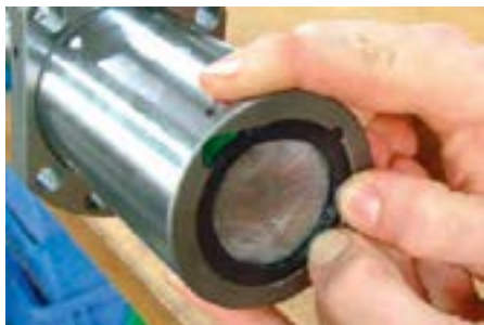
Fig. 10.6 Fermare la tenuta NBR/TPU mentre si monta lentamente la chiocciola sull'albero
