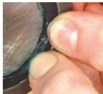
Fig. 10.6 Fermare la tenuta NBR/TPU mentre si monta lentamente la chiocciola sull'albero
