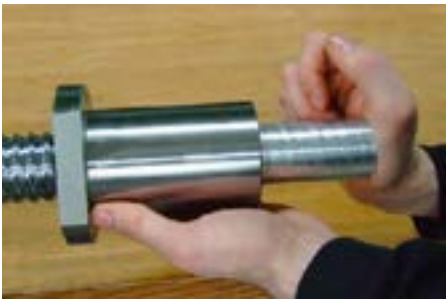
Fig. 10.5 Montaggio della chiocciola con tenuta NBR/TPU sull'albero
